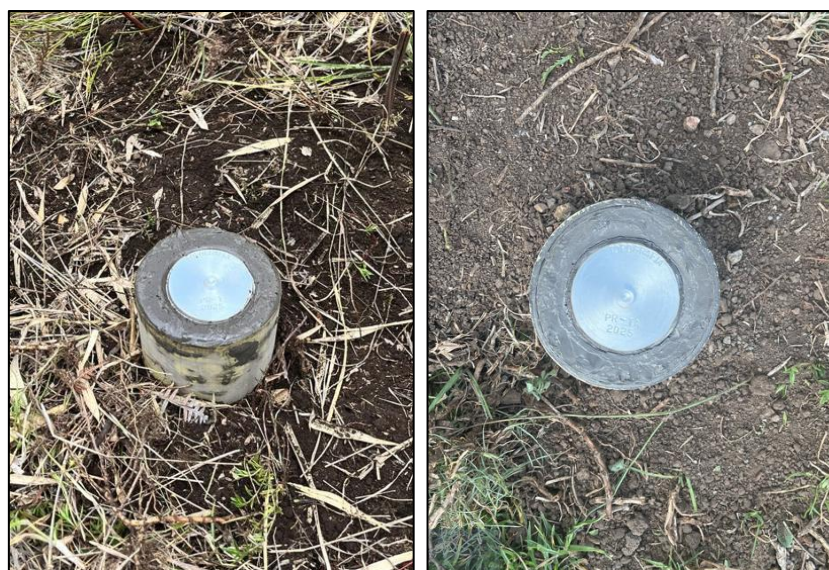
Ilustración 2. Imagen de mojón fundido en tubo de PVC de 4", con placa de referencia en aluminio. Fuente: Levantamiento topográfico – 2025.
