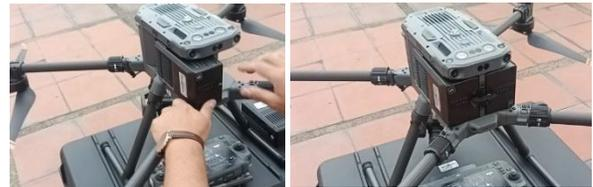
*Nota: Si el pasador no gira porque una de las baterías sobresale, se debe revisar e instalar nuevamente la batería.*
