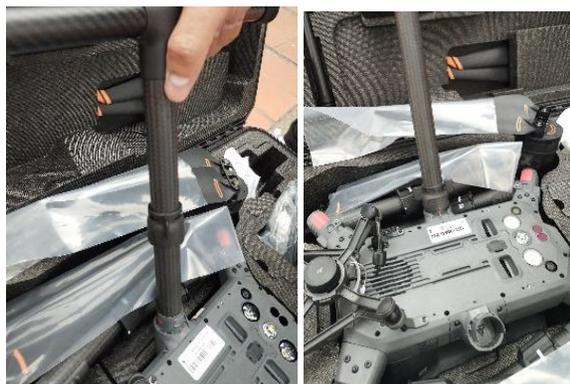
3. Retire la aeronave sujetándola con las dos manos del tren de aterrizaje, dándole la vuelta para que el dron quede apoyado sobre el mismo.
