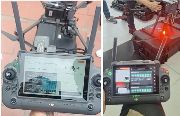
32. La aplicación realizará una autocomprobación de los motores, el nivel de la batería, la transmisión de la imagen, el posicionamiento visual, las cámaras y el RTK.
