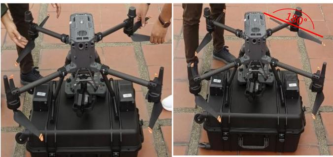
27. Separe el protector del lente de la cámara, y retire los elementos que puedan obstaculizar la cámara.
