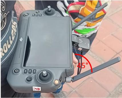
25. Encienda el RC oprimiendo el botón de encendido dos veces, la primera a un toque y el segundo con una duración de 3 segundos.
