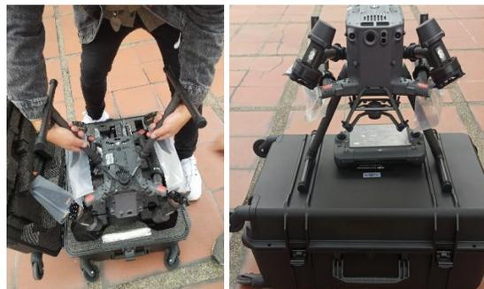
4. Despliegue los brazos de la aeronave inicie con el brazo trasero, posteriormente despliegue el brazo delantero, tenga en cuenta que las hélices del brazo trasero deben pasar por encima del brazo delantero. Por ningún motivo ejerza presión sobre los brazos o hélices ya que estos no se deben tocar y/o cruzar con presión.
